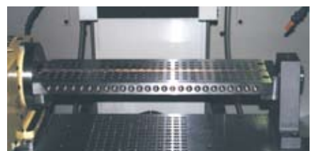
Spannbrücke mit Wiegenplatte Clamping bridge with central base plate
