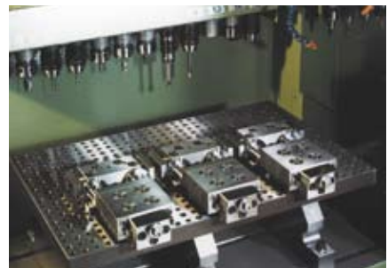
Aufspannplatte mit Unterbausatz Base plate with substructure
