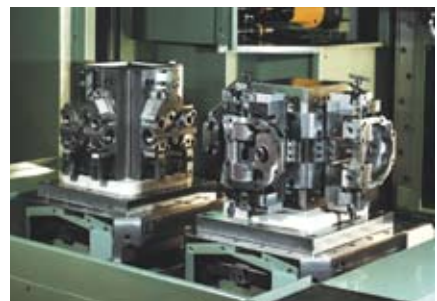
Wechselpaletten mit Aufspannwürfel Pallets with clamping column
