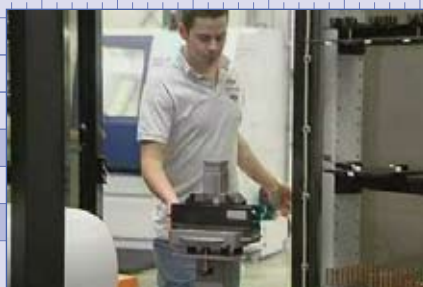
Automationszelle beladen und bestückte Paletten in Magazin einfahren Loading the automation cells and inserting the pallets into work piece stock
